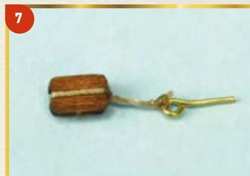
**7** Следуя инструкциям выпуска 124, изготовьте несколько одношквивных блоков, обвяжите их нитью цвета «экрю» диаметром 0,15 мм и привяжите к ним рым-болты
